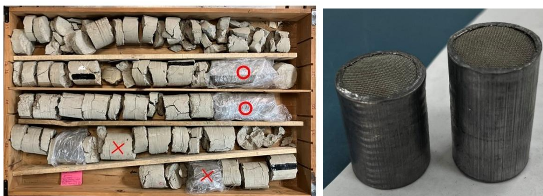
Slika 7: Odvzem vzorcev iz jeder za laboratorijske hidrogeološke preiskave na INA Zagreb
