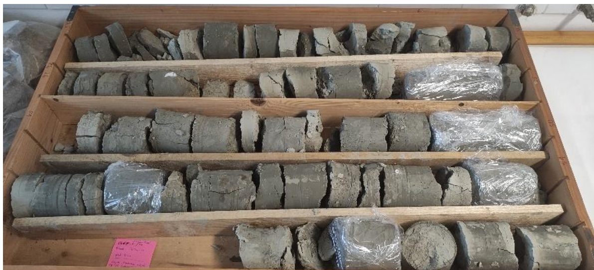
Slika 29: Dve jedri lapornatega melja (iz globin 24,0 do 26,0 m in 50,0 do 52,55 m); skeniranje s TCS merilnikom se je izvedlo na 14 večjih kosih obeh jeder.
