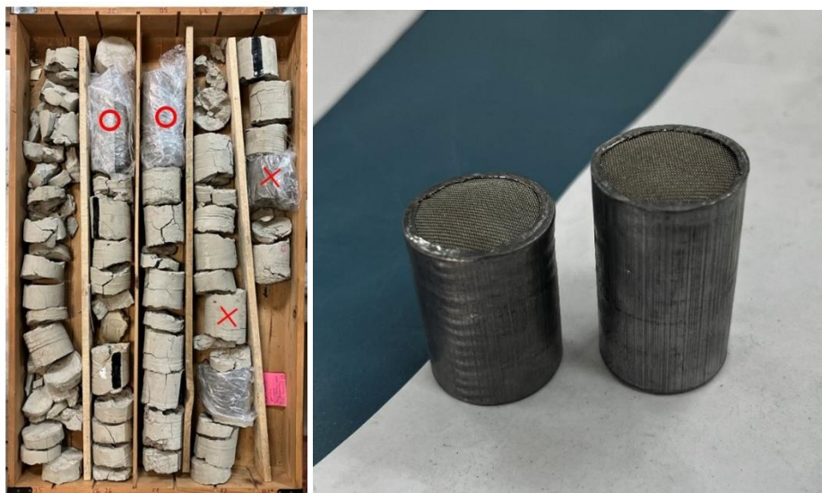
Slika 18: Odvzem vzorcev iz jeder za laboratorijske hidrogeološke preiskave na INA, Zagreb
