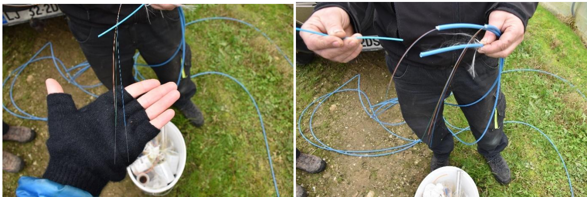
Slika 7: Izgled optičnega kabla, ki je bil vgrajen v geosondo
