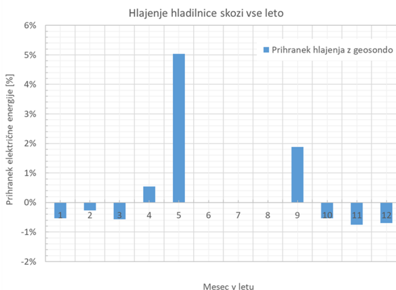
Slika 4 Mesečni prihranek električne energije pri vodno hlajenem chillerju z geosondo v primerjavi z uporabo zračno hlajenega chillerja.
